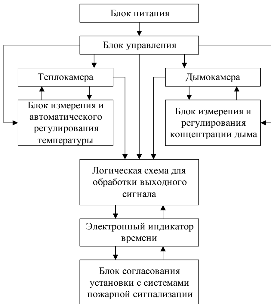
Рис. 3.15. Структурная схема универсального стенда для снятия характеристик пожарных извещателей
