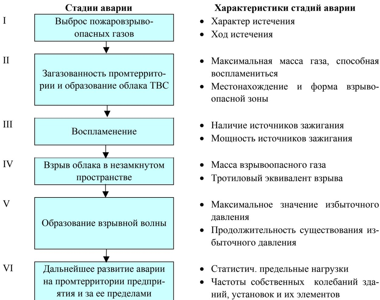
Рис. 1. Примерные стадии и характеристики развития аварии с выбросом горючих газов
