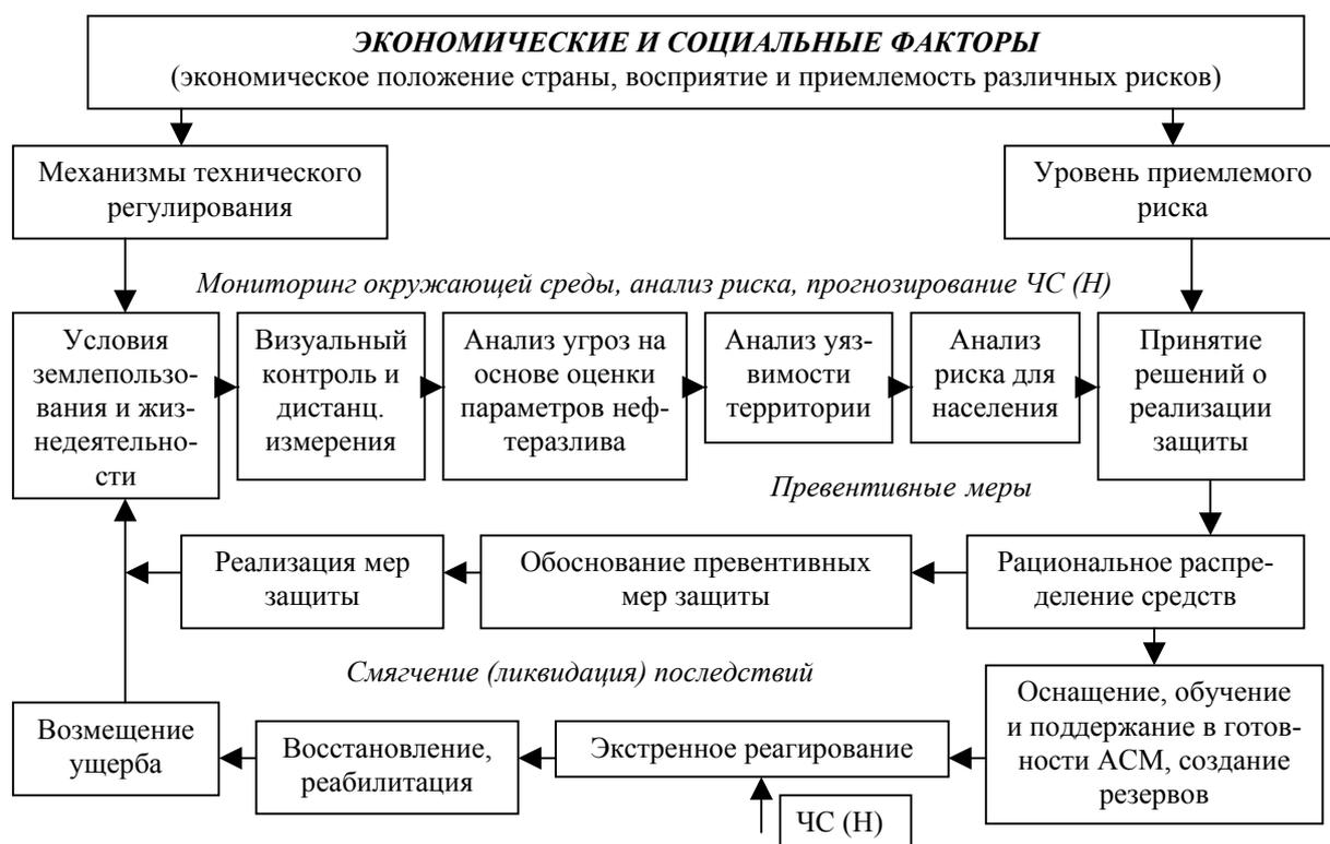
Рис. 1. Структура системы мониторинга обстановки в зоне ЧС(Н)
