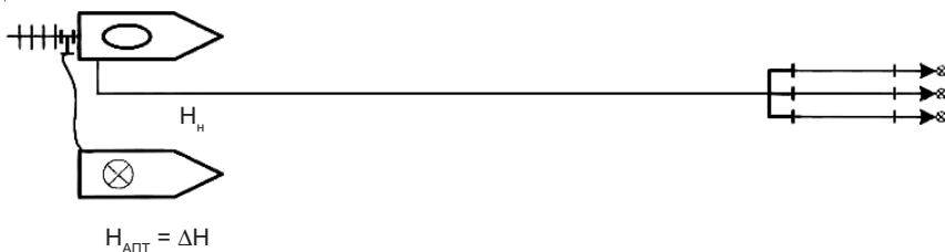
Рис. 16.7. Подача пенообразователя от АПТ во всасывающую полость насоса
