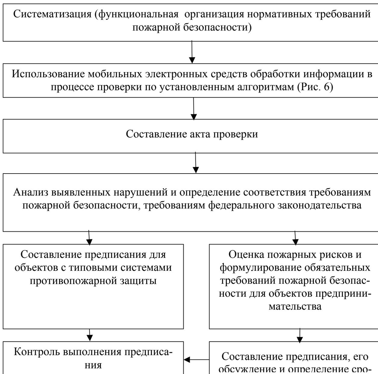
Рис. 7. Алгоритм применения комбинированной методики проверки противопожарного состояния объектов
