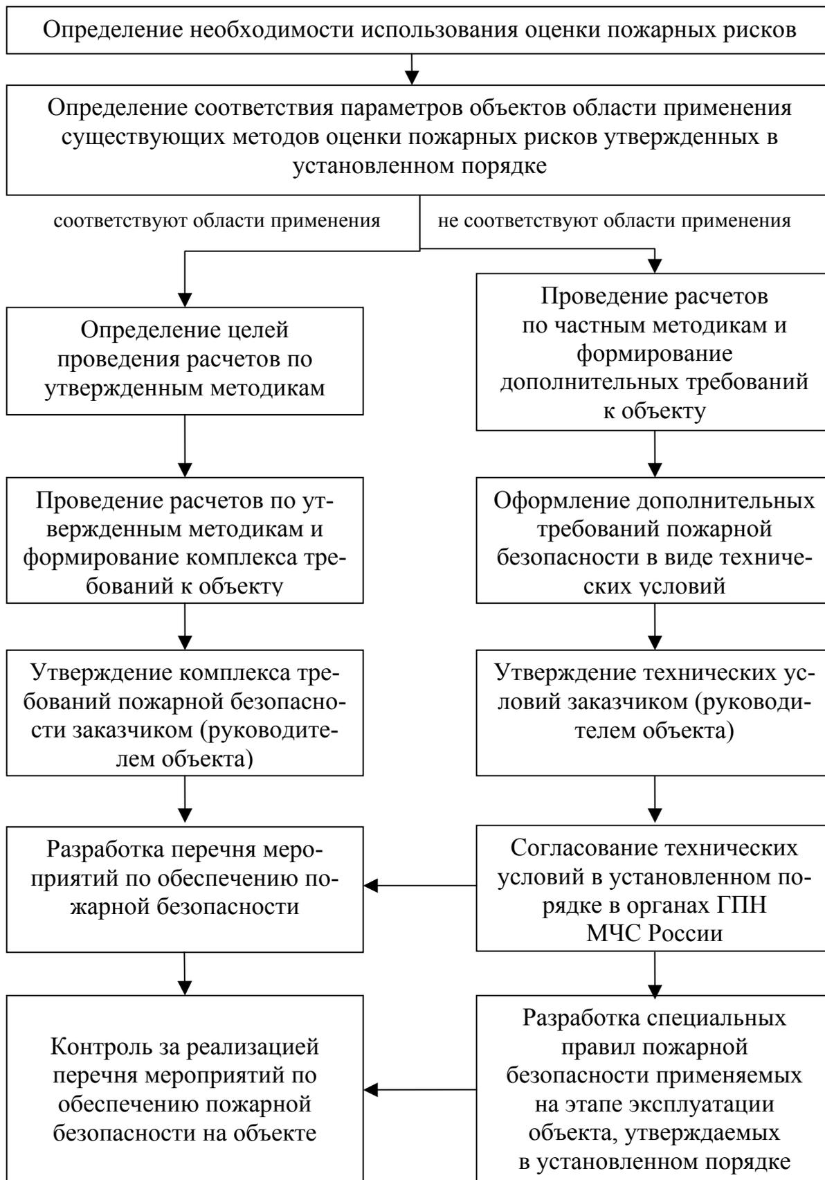
Рис. 10. Порядок проведения проверок противопожарного состояния объектов при осуществлении аудита пожарной безопасности с использованием оценки пожарных рисков
