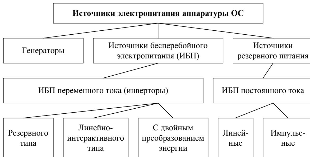
Рис. 1. Классификация основных видов источников электропитания аппаратуры систем безопасности
