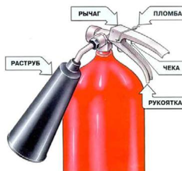
Рис. 2. Устройство углекислотного огнетушителя
