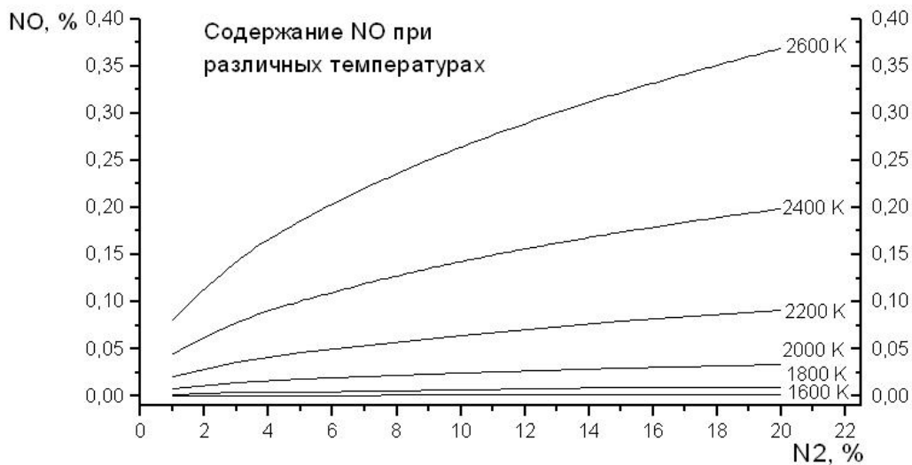
Рис. 3. Зависимость количества образующегося NO в продуктах горения метана в окислительной среде ( O_2 + N_2 + CO_2 ) при увеличении содержания N_2
