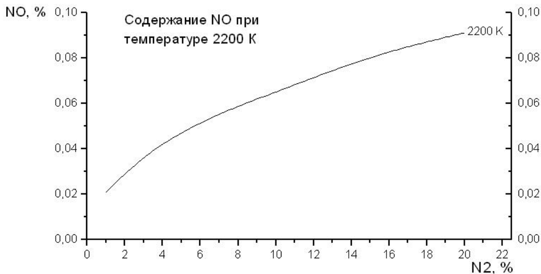
Рис. 4. Количества образующегося NO в продуктах горения метана в окислительной среде ( O_2 + N_2 + CO_2 ) при температуре 2200 К
