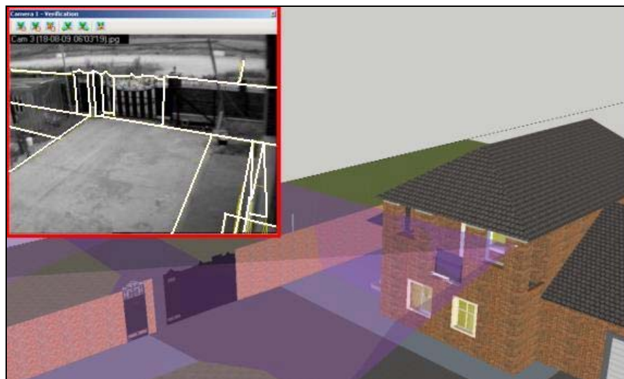
Рис. 3. Верификация снимка с реальной видеокамеры
