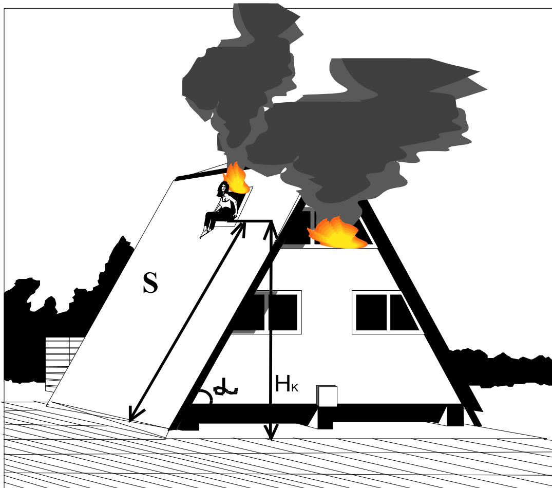
Рис. 1. Схема скольжения человека по наклонной поверхности с последующим ударом о твердую поверхность
