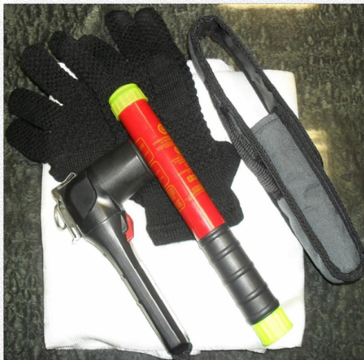
Рис. 4. Комплект снаряжения сотрудника МЧС, выполняющего функции дозорного: аэрозольный огнетушитель (предназначенный для тушения классов пожаров А, В, С); кошма; хлопчатобумажные перчатки; фонарь электрический индивидуальный
