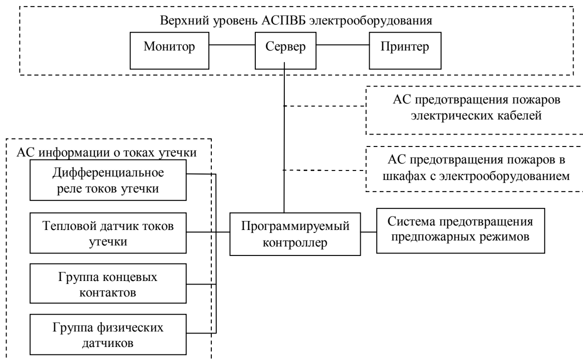
Рис. 5. Структура автоматизированной подсистемы предотвращения предожарных режимов электродвигателей при обнаружении токов утечки
