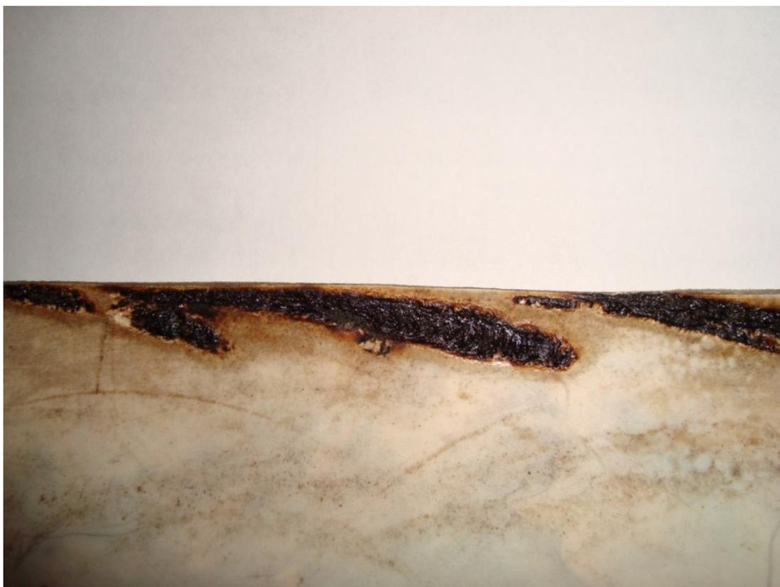
**Рис. 8.** Фотография линолеума после светового воздействия солнечных лучей. Видны следы горения. Эксперимент повторялся 5 раз, свет фокусировался на разные части линолеума
