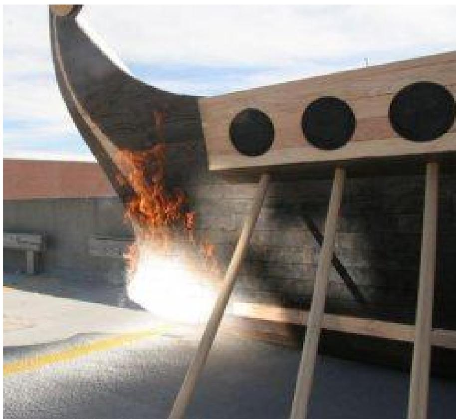
**Рис. 3.** Горение деревянного макета корпуса корабля
