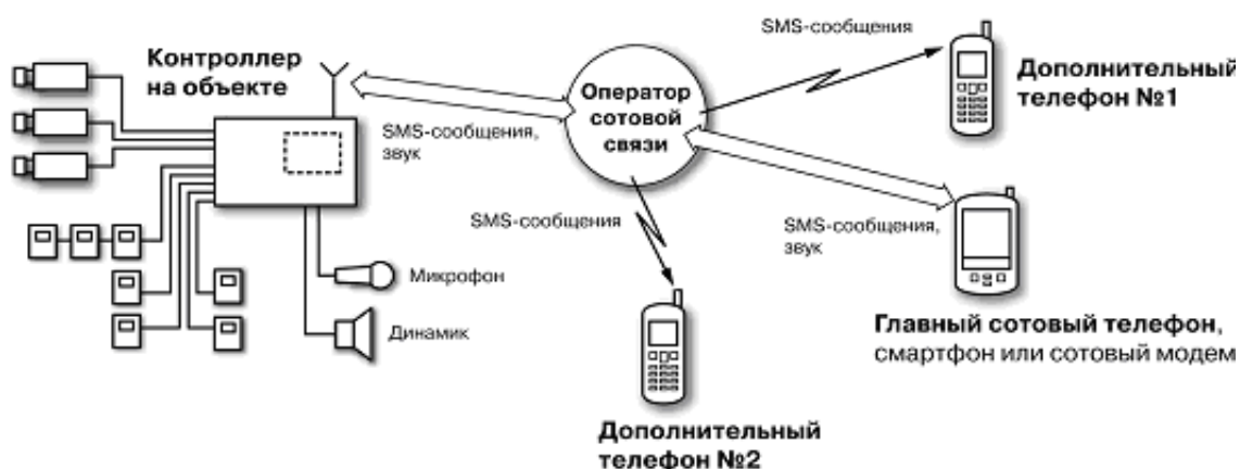
Рис. 1. Схема передачи информации в GSM-охранной системе при использовании функции SMS
