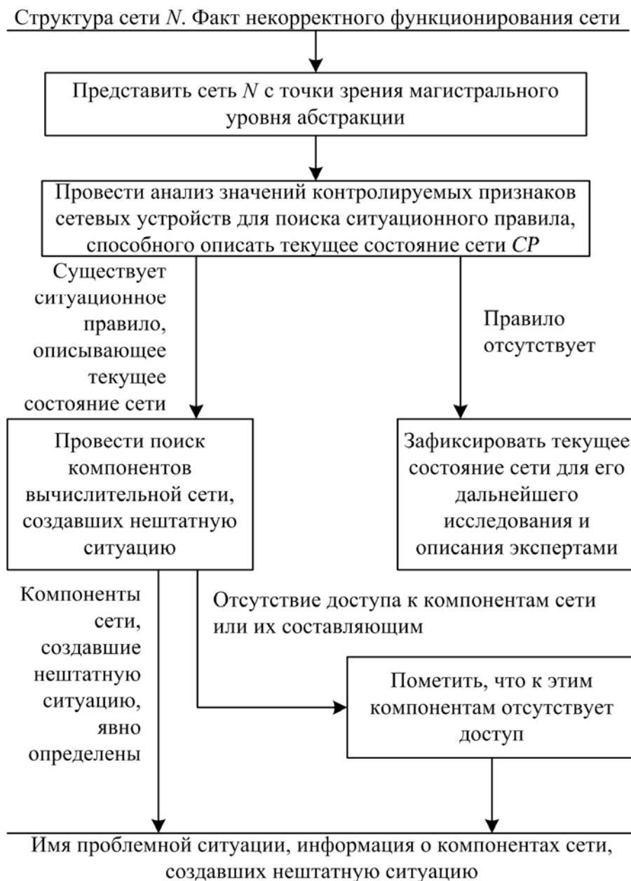
Рис. 1. Последовательность поиска компонентов сети, вызвавших нарушение её функционирования
