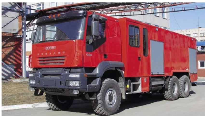
**Рис. 3.** Пожарная автоцистерна АЦ-7,0-150 (6339) с производительностью насосной установки 150 л/с
