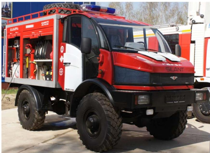
**Рис. 7.** Мобильный комплекс "Гюрза". Размещение пожарно-технического вооружения
