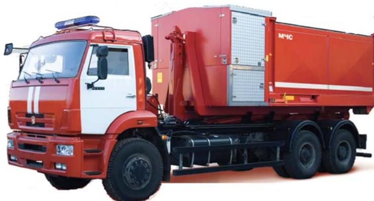
**Рис. 4.** Насосно-рукавный комплекс НРК "Поток" на шасси КамАЗа 6520
