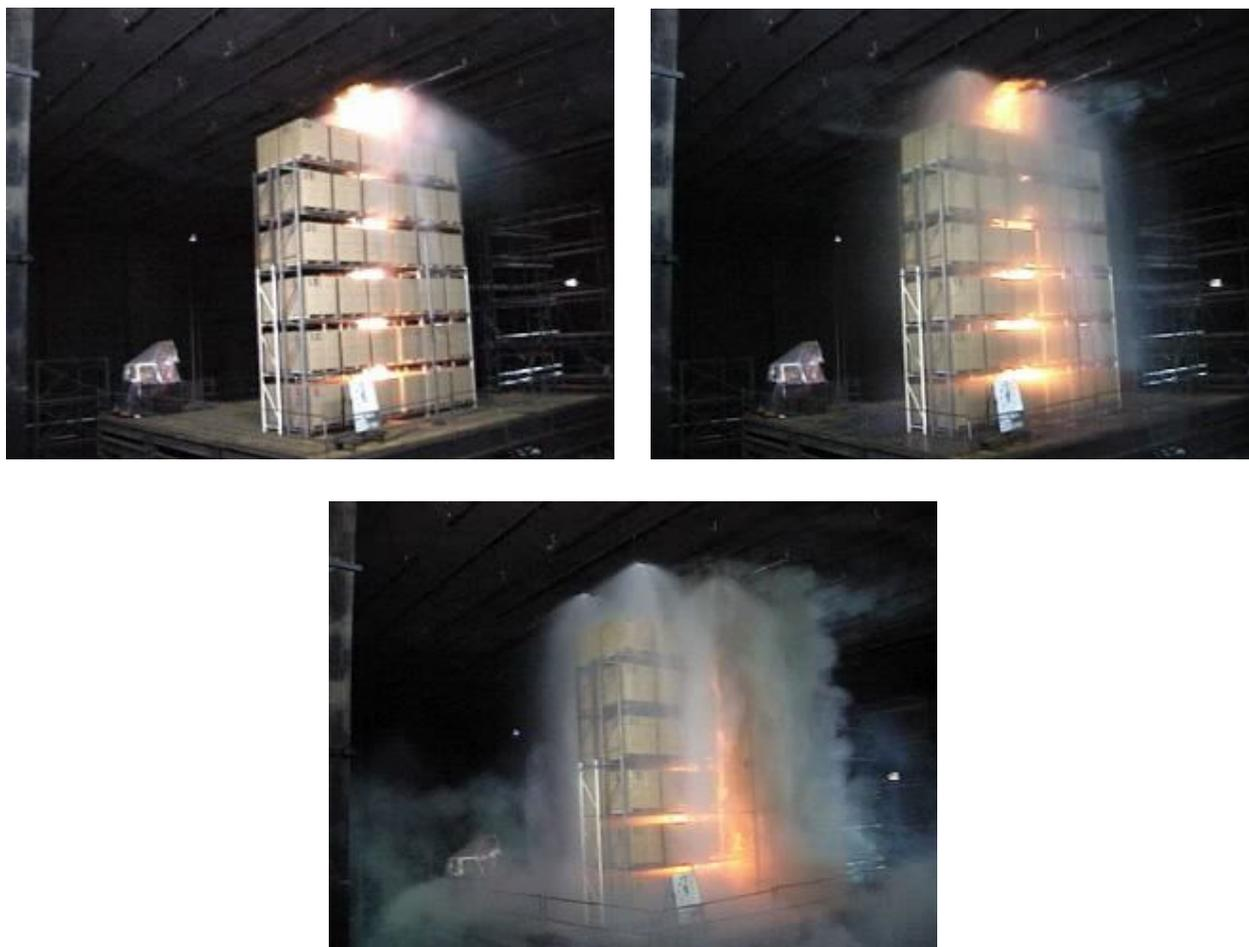
**Рис. 4.** Процесс локализации пожара при последовательном срабатывании четырёх оросителей с расширенной картой орошения
