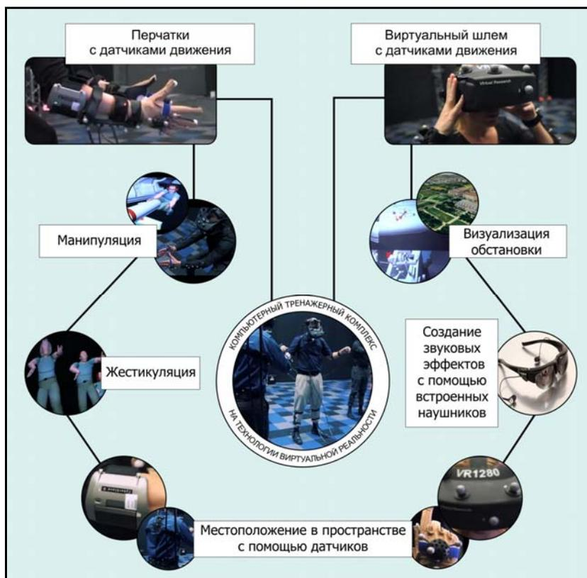
**Рис. 5.** Схема реализации технологии виртуальной реальности в компьютерных тренажёрных комплексах
