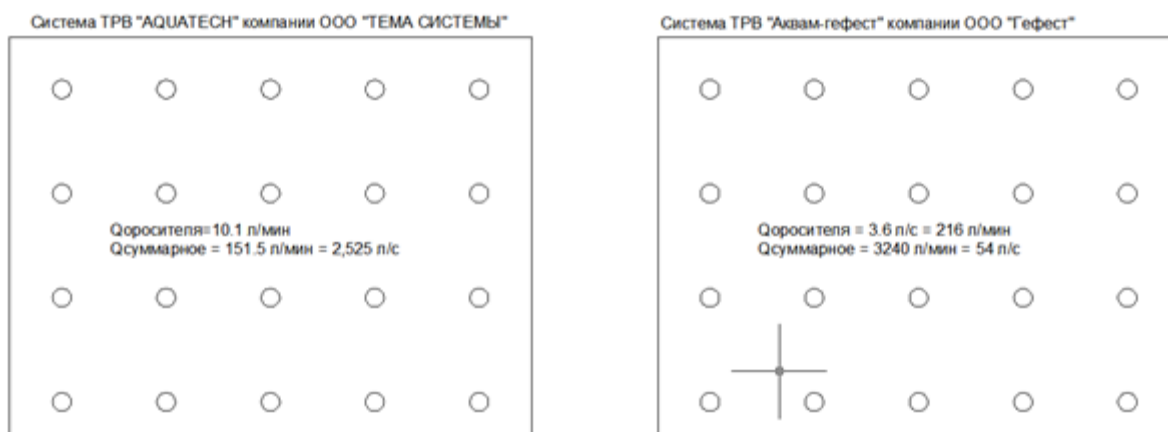
Рис. 4. Схемы размещения оросителей для двух систем ТРВ
