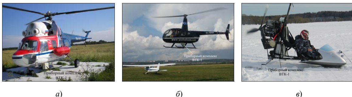
Рис. 2. Приборный комплекс ВТК-1 на несущих летательных аппаратах: а – вертолёт Ми-4; б – вертолёт Robinson; в – дельталёт "Форсаж"
