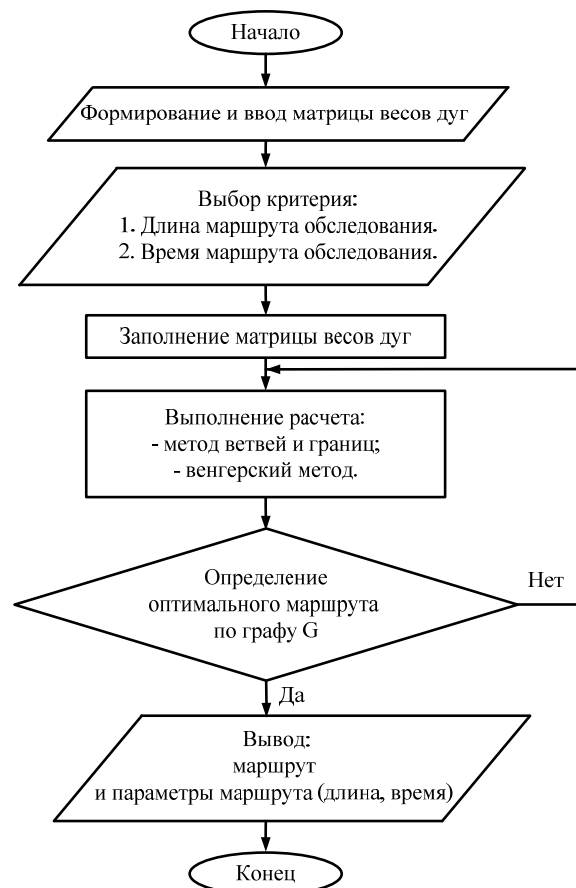
Рис. 5. Блок-схема алгоритма определения оптимального маршрута обследования завалов спасателями
