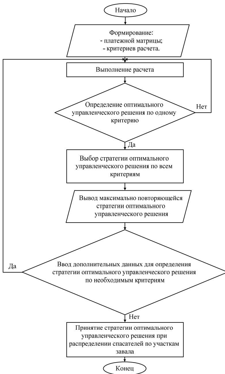
Рис. 8. Блок-схема теоретико-игрового алгоритма принятия управленческого решения при распределении спасателей на завалах
