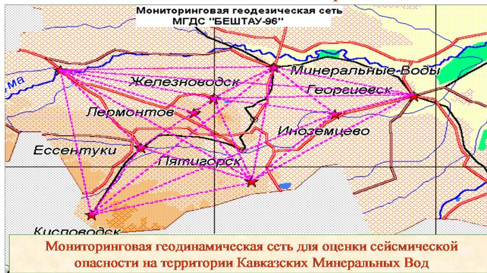
Рис. 1. Схема геодеформационных наблюдений на Кавказских Минеральных Водах
