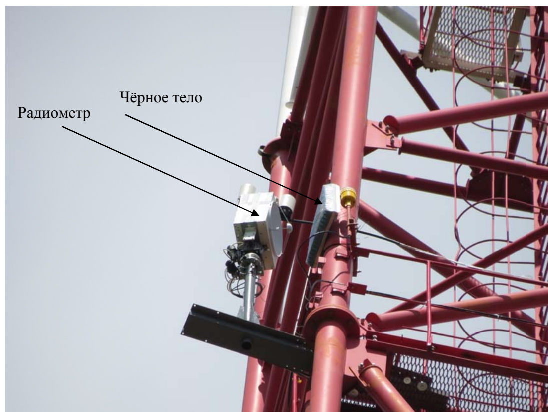
Рис. 5. Калибровка по черному телу проходит в начале каждого скана
