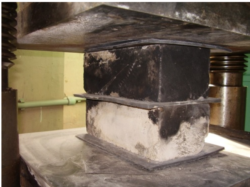
Рис. 3. Общий вид образцов, помещённых в пресс П-125, перед проведением испытания
