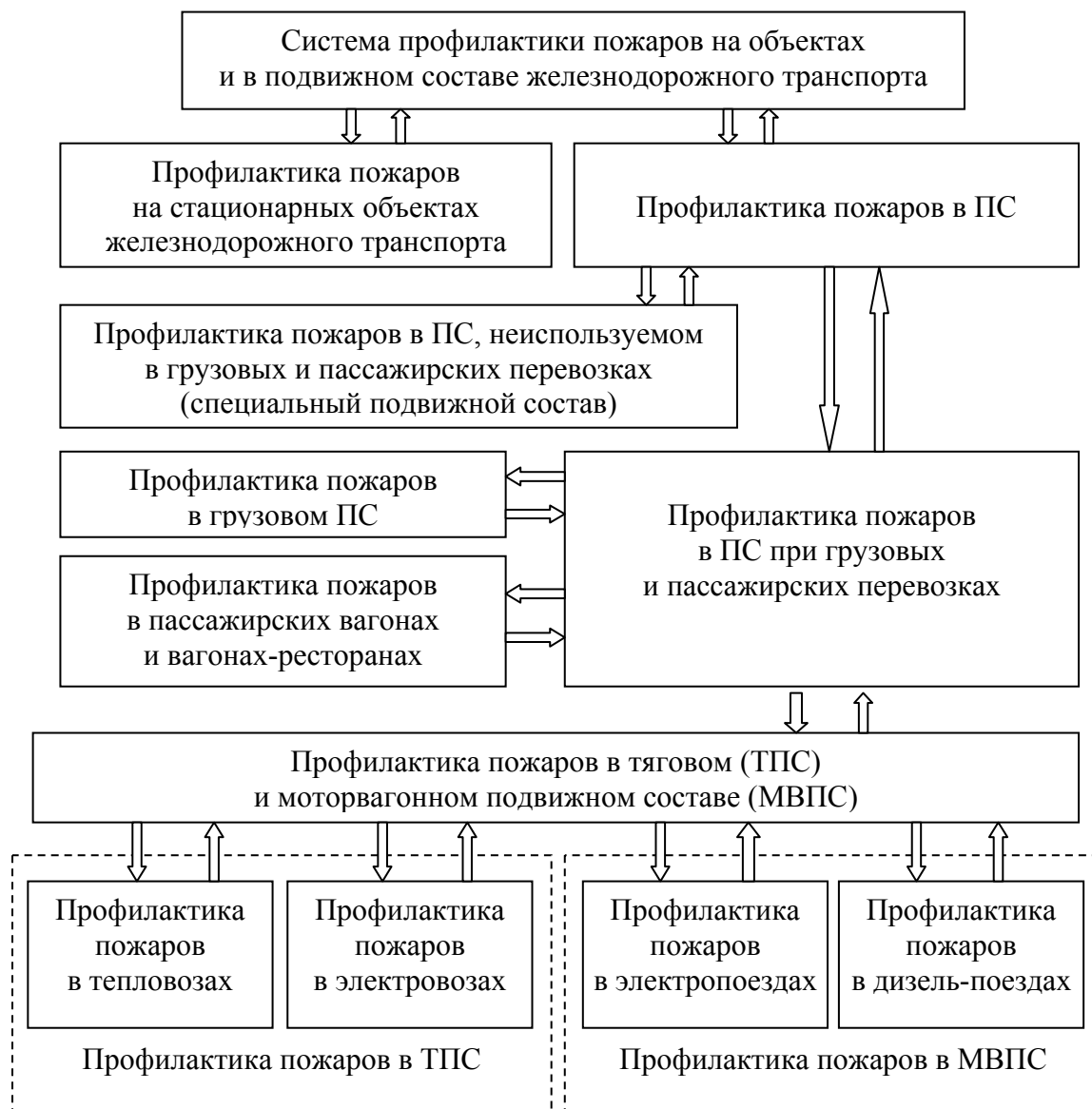
Рис. 1. Структура системы профилактики пожаров на стационарных объектах и в подвижном составе железнодорожного транспорта
