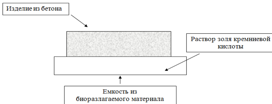
Рис. 6. Схема упрочнения изделия бетона методом капиллярного подсоса кремнезолом при укладке ленточного фундамента
