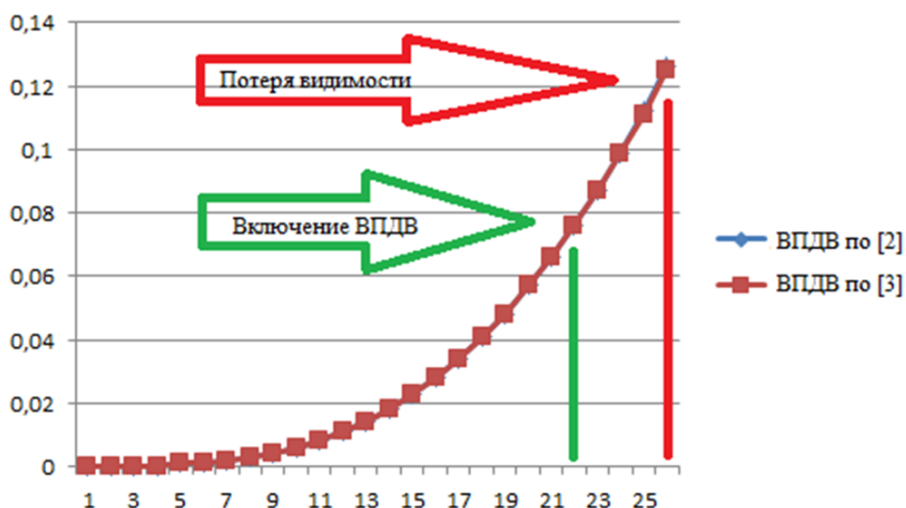
Рис. 2. Динамики изменения оптической плотности среды ( Hn/м ) во времени ( c ) при пожаре в помещении, оснащённом системой ВПДВ, спроектированной по разным нормативным документам
