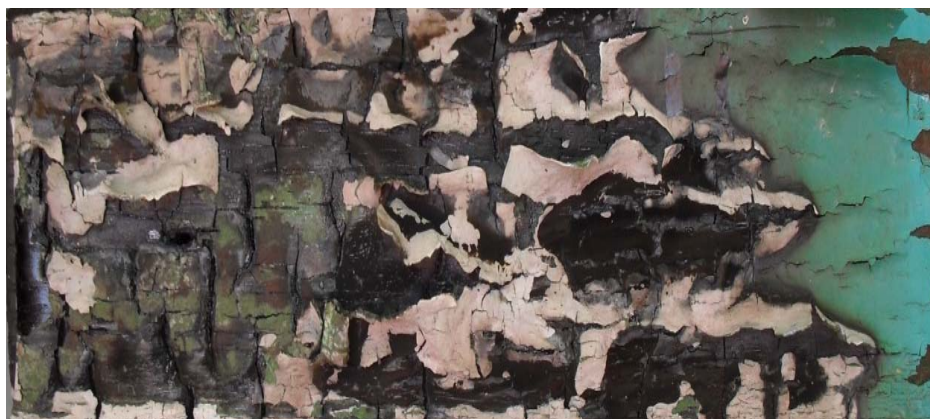
Рис. 2. Фото образца древесины с лакокрасочным материалом после огневых испытаний по ГОСТ 12.1.044-89 п. 4.19
