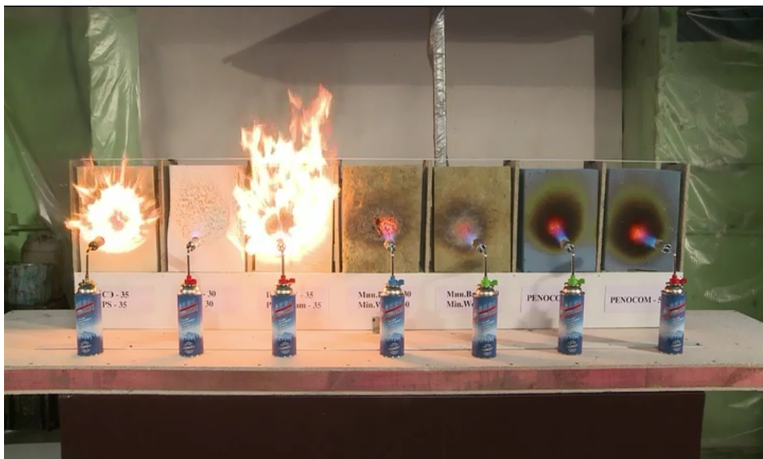
Рис. 2. Испытания на возгораемость: поведение материалов через 10 секунд после начала испытаний; слева-направо: ППЭ, ПСБ, ППУ, МВ-50 и -70, PENOCOM-30 и -50
