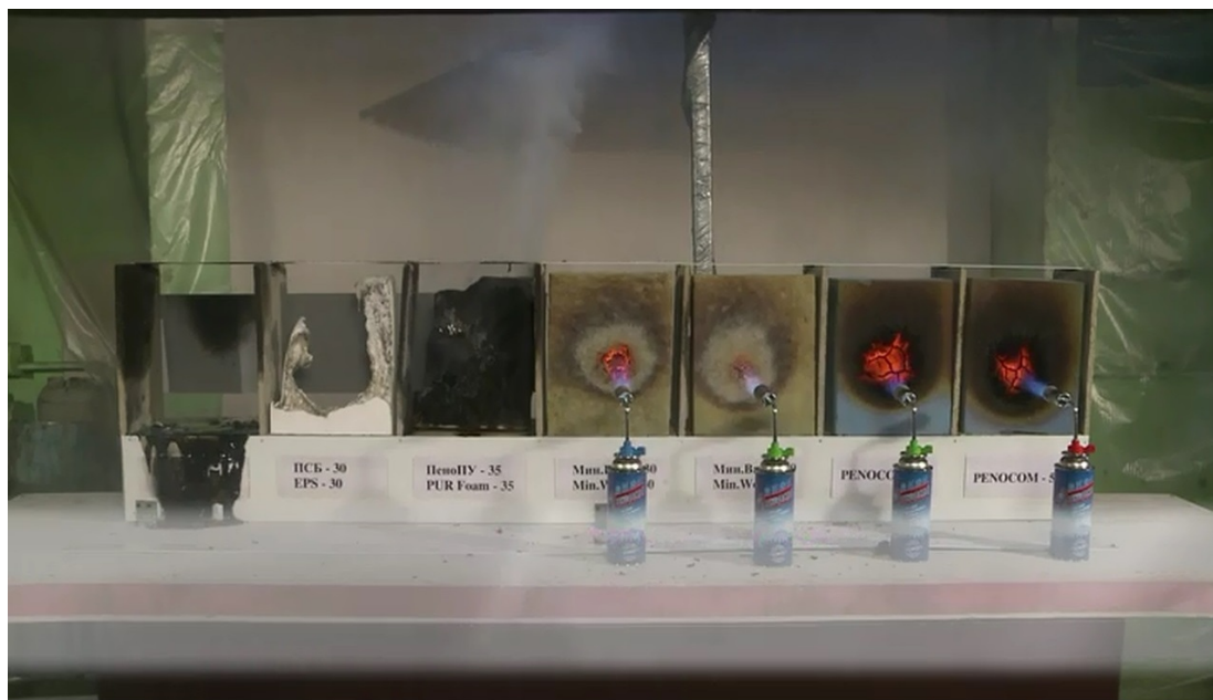
Рис. 3. Испытания на возгораемость: поведение материалов через 10 минут после начала огневых испытаний
