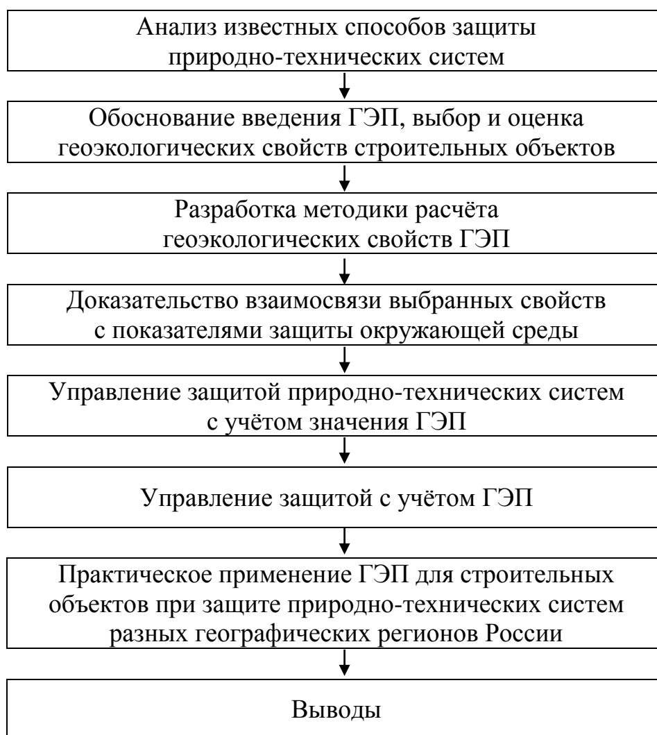
Рис. 1. Структура метода защиты природно-технических систем с учётом геоэкологических свойств строительных объектов
