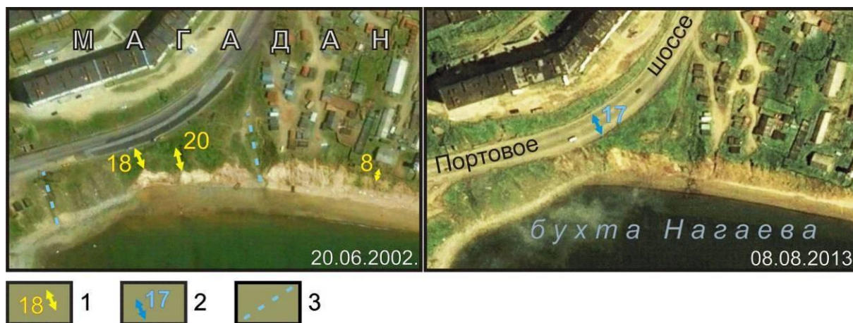
Рис. 21. Активизация склоновой денудации на северном фланге Восточного клифа Нагаевской бухты: 1 – ширина берега, уничтоженного обвально-оползневыми процессами за период 2002-2013 гг.; 2 – ширина Портового шоссе с обочиной; 3 – ручьи
