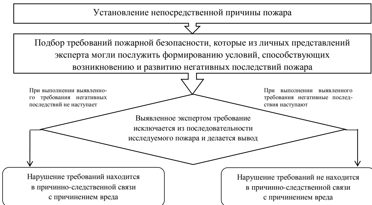
Рис. 1. Блок-схема алгоритма метода мысленного исключения
