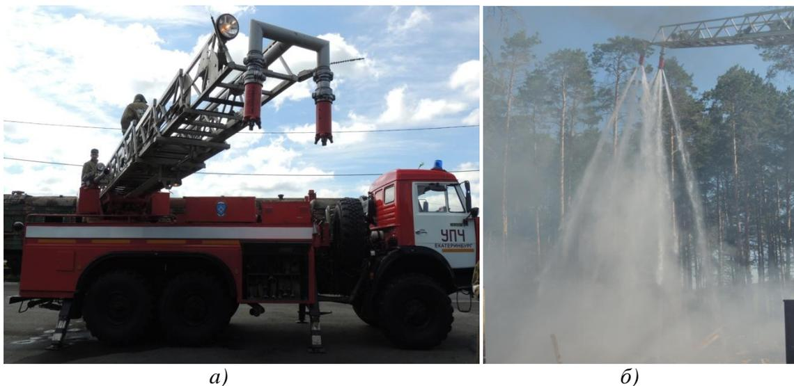
Рис. 3. Подвеска (а) и работа (б) системы из двух СПВЗ
