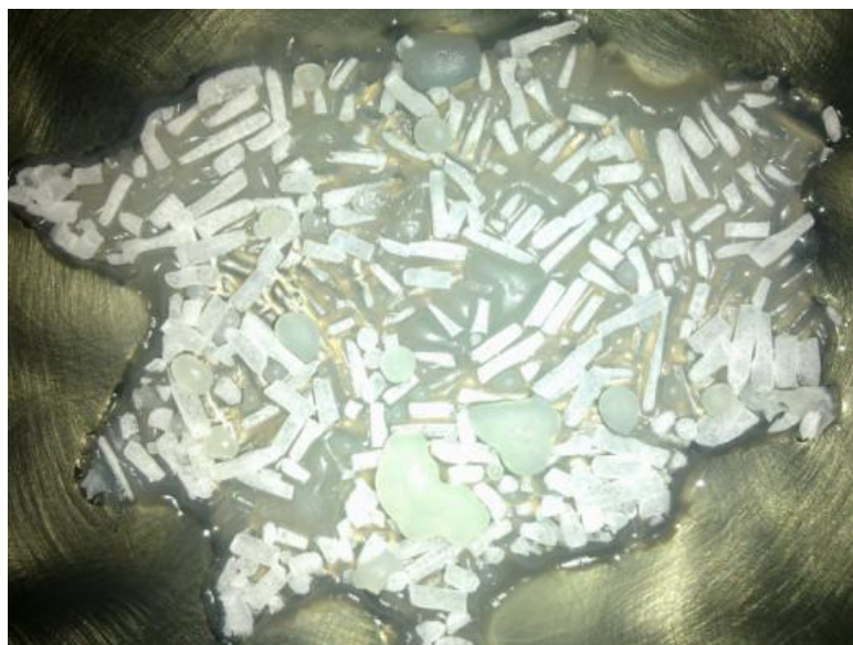
Рис. 5. "Температурный шок" при подаче критического количества ТГДУ в ДТ
