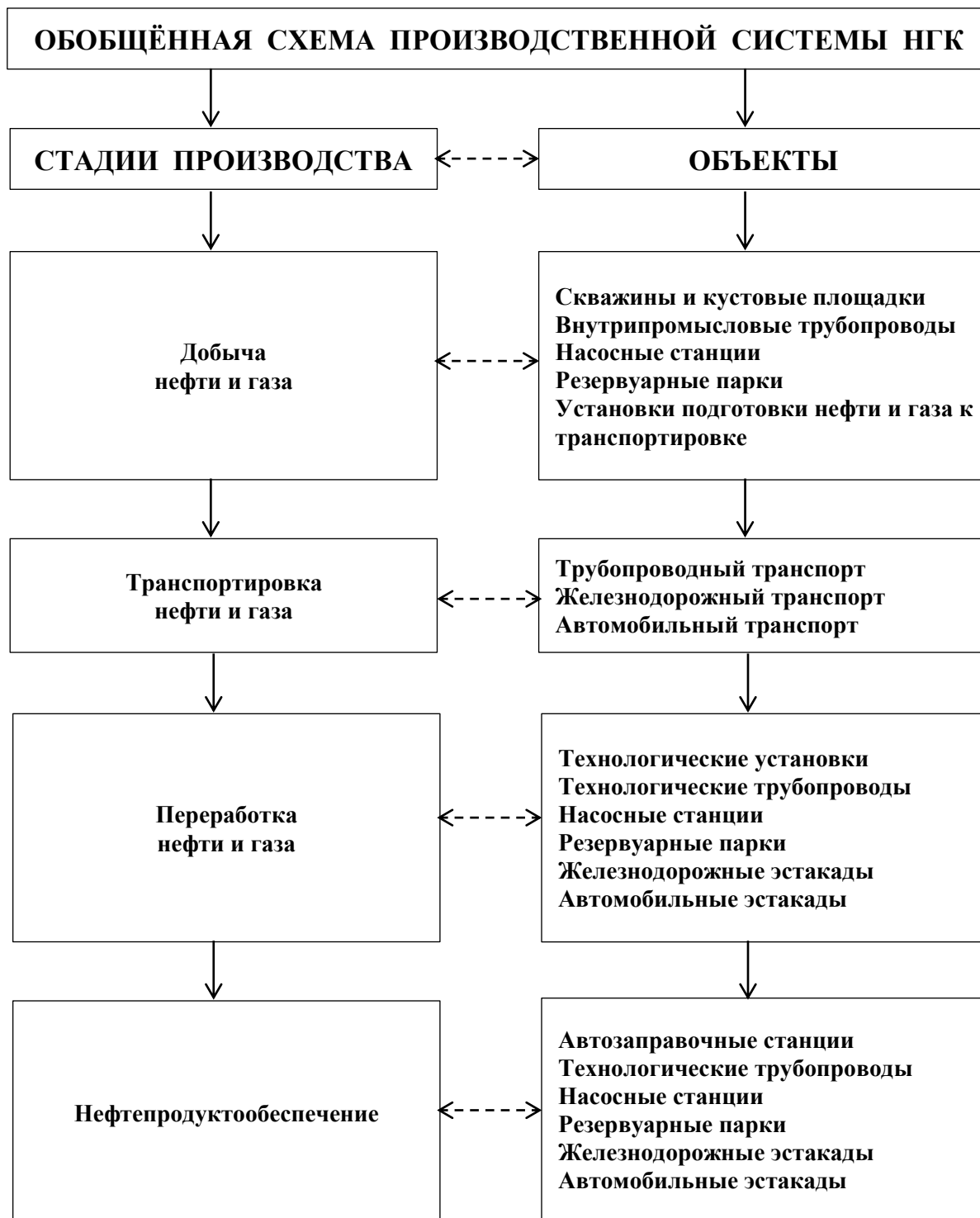
Рис. 1. Обобщённая схема производственной системы НГК
