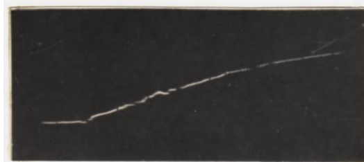
Рис. 9. Импульс термодатчика полного теплового потока ( V_S = 4,3 км/с; p_1 = 10 мм.рт.ст.)
