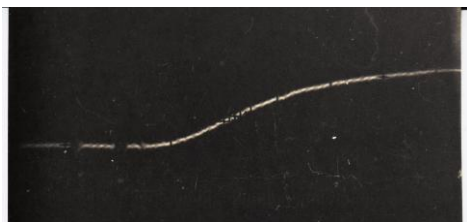
Рис. 8. Импульс термодатчика лучистого теплового потока ( V_S = 7,7 км/с; p_1 = 1 мм.рт.ст.)
