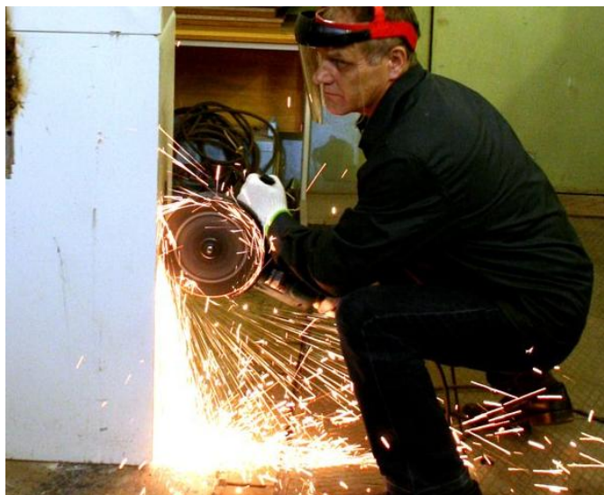
Рис. 6. Процесс разрушения сейфового отсека банкомата электрической дисковой пилой
