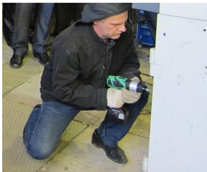
Рис. 5. Процесс разрушения электродрелью
