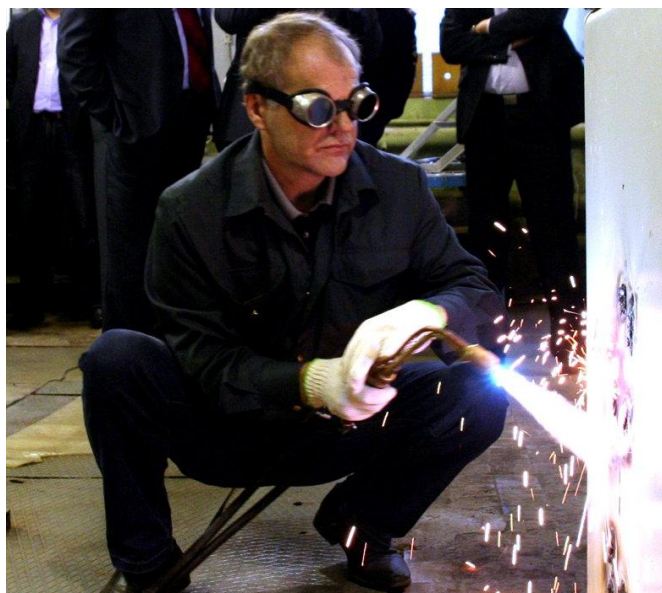
Рис. 7. Процесс разрушения сейфового отсека банкомата газовым резаком
