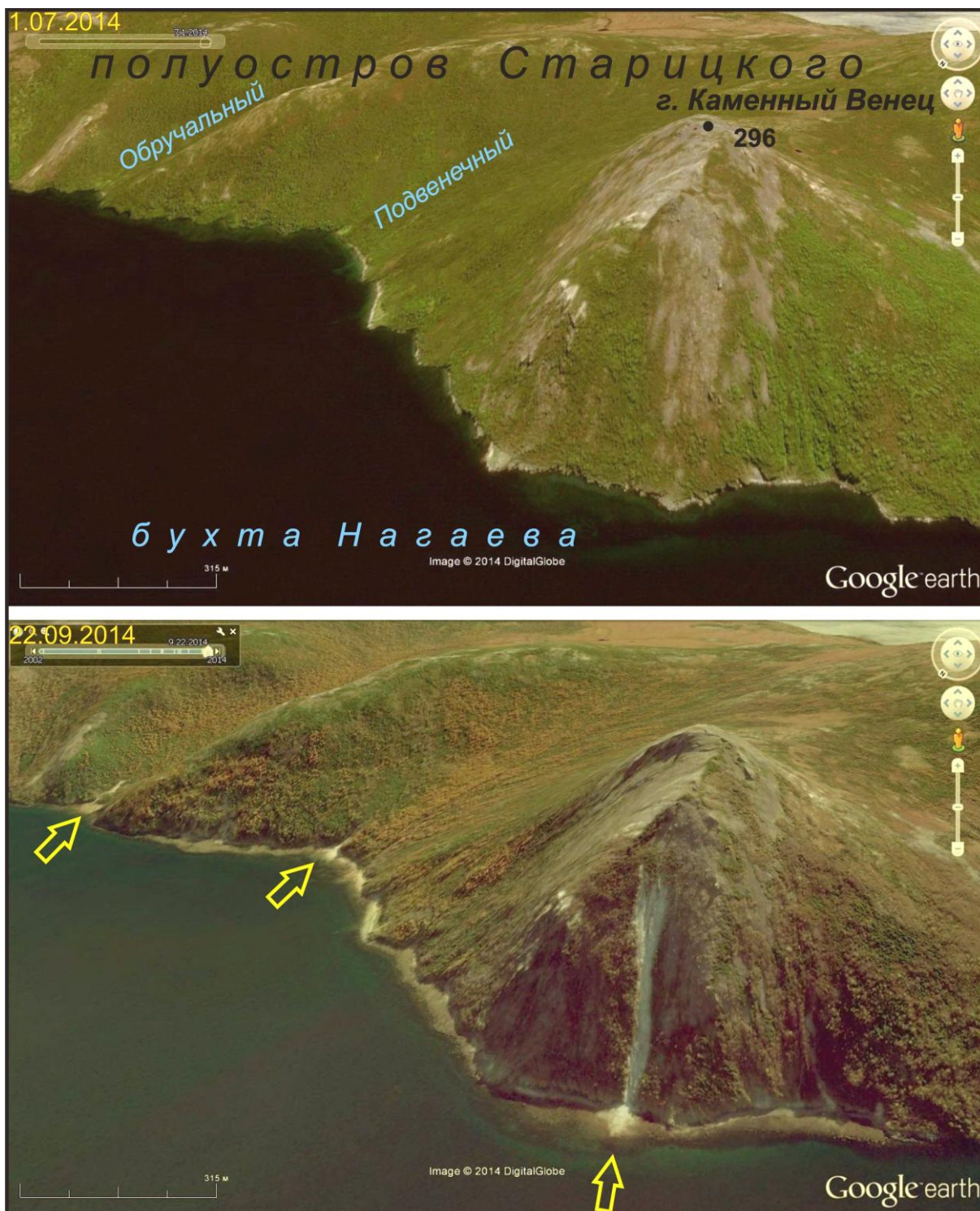
Рис. 8. Южный берег бух. Нагаева до и после паводка. Со склона горы Каменный Венец сошел крупнейший в 2014 г. оползень (точнее обвал-оползень или каменная лавина). Длина этой структуры – вместе с нишей отрыва – около 480 м по падению склона. Менее крупные оползни возникли вблизи устьев ручьев Обручальный и Подвенечный
