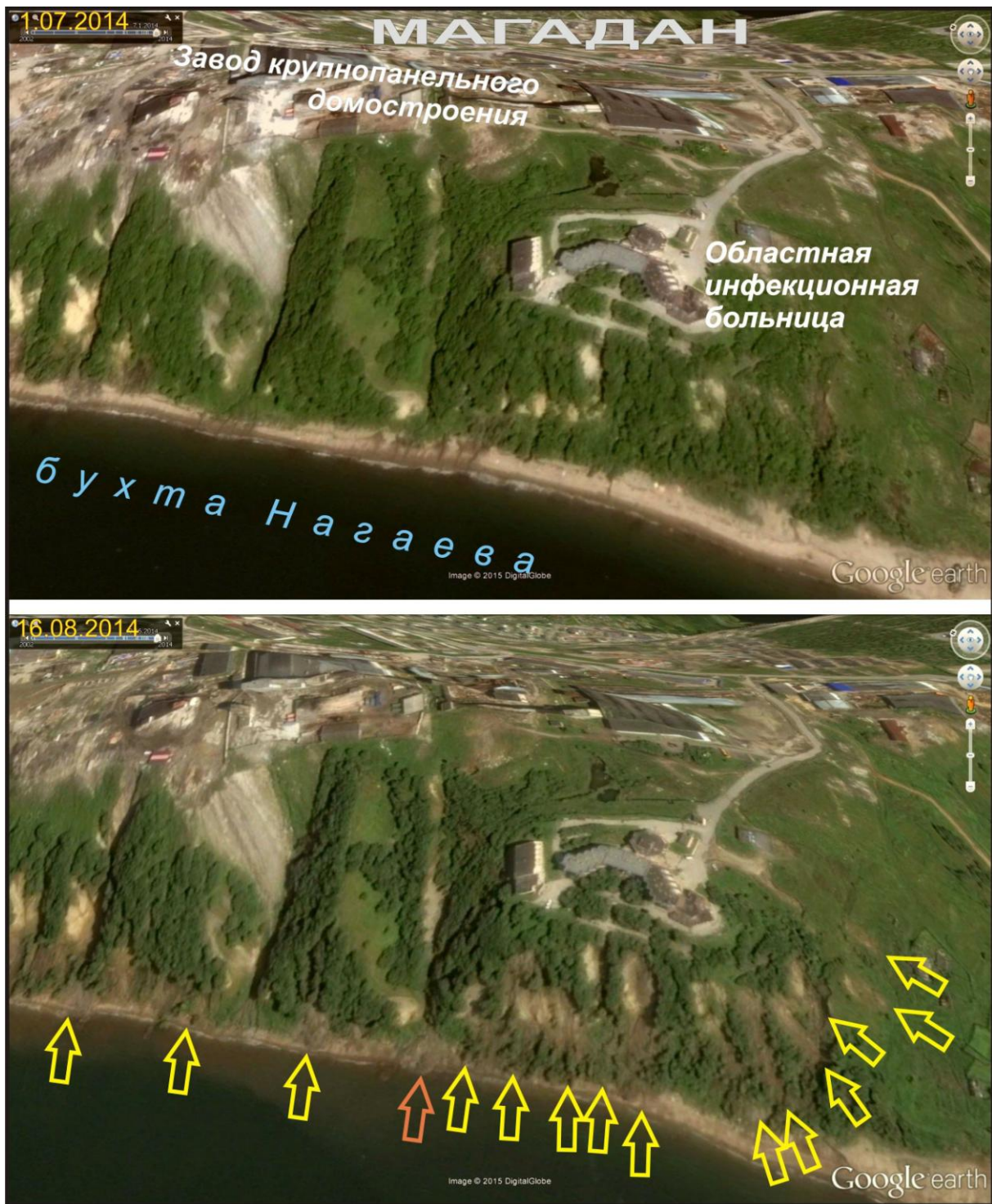
Рис. 11. Серия многочисленных малых оползней размерами до 50-70 м и подновленный эрозией овраг (показан красной стрелкой) длиной 110 м, на южном фланге Восточного клифа бух. Нагаева, сложенного слабо литифицированными алевролитами и аргиллитами нагаевской толщи миоцена
