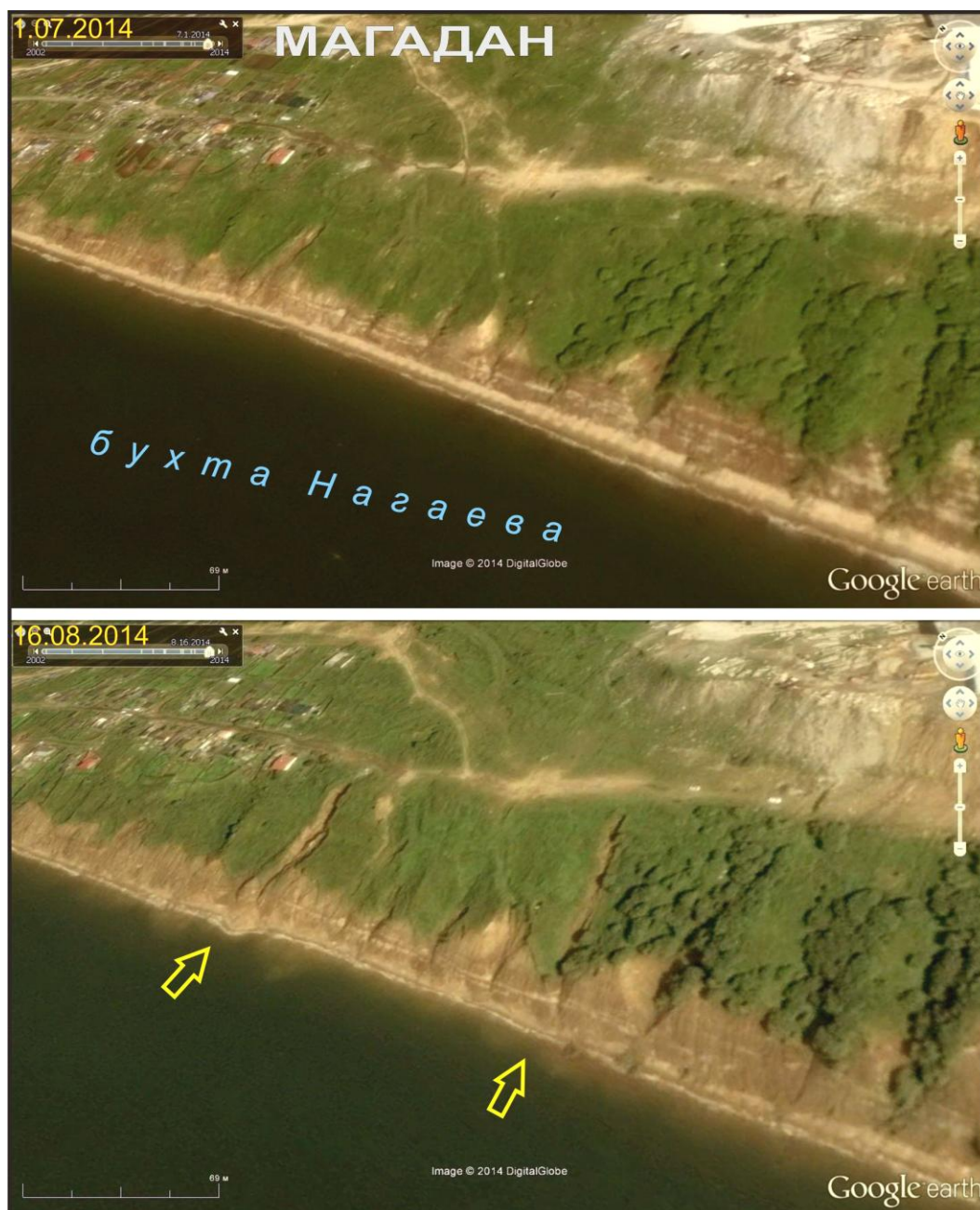
Рис. 12. Два оврага, врезавшиеся вследствие ливней в Восточный клиф бух. Нагаева: новый – длиной до 110 м и другой, увеличившийся в два раза в размерах, и их конусы выноса на пляже
