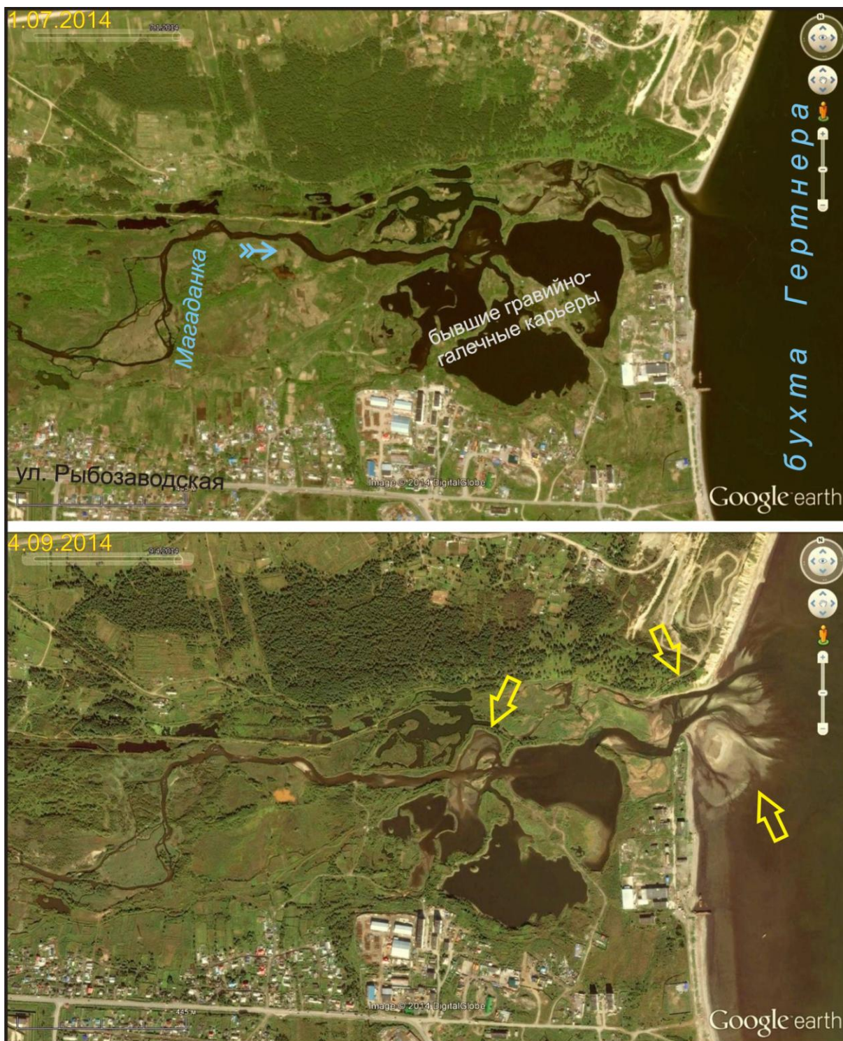
Рис. 7. Устье р. Магаданка до и после паводка. Произошел размыв северной части пересыпи в устье реки и значительный рост подводных дельт на литорали и в северо-западном карьере. Картина изменений представляется несколько выразительней из-за меньшего приливного уровня нижнего (более позднего) снимка
