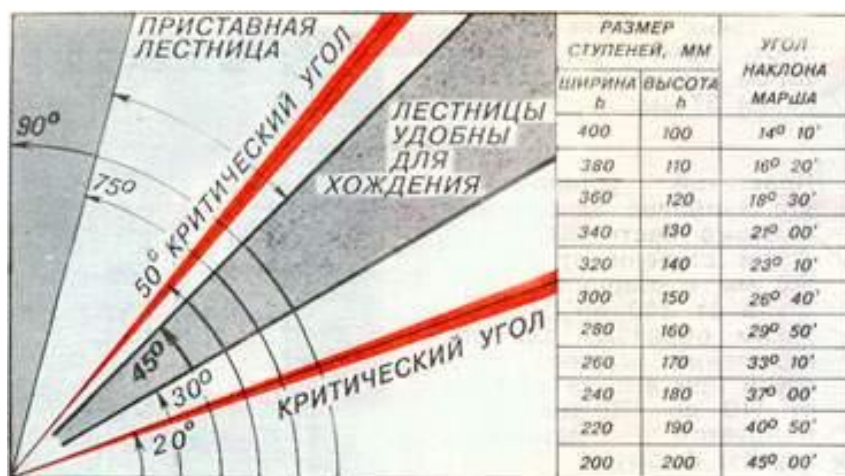
Рис. 3. Оптимальные уклоны лестниц [6]
