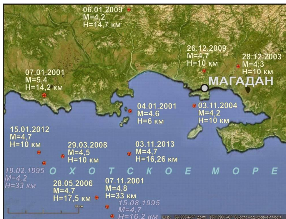
Рис. 1. Эпицентры землетрясений Примагаданья за период 2001-2013 гг., по данным из слоя "Землетрясения" интернет-сервиса Google Earth: M – магнитуда; H – глубина очага землетрясения
