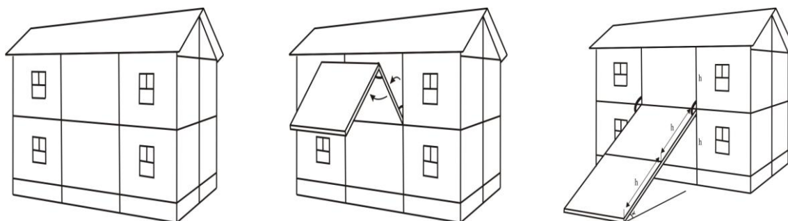
Рис. 2. Последовательность трансформации секций второго этажа
