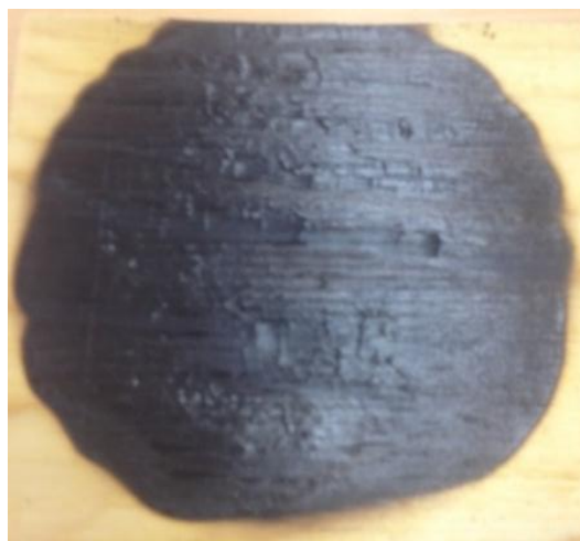
Рис. 1. Элемент деревянной клееной балки типа LVL после огневых испытаний по ГОСТ 30402-96
