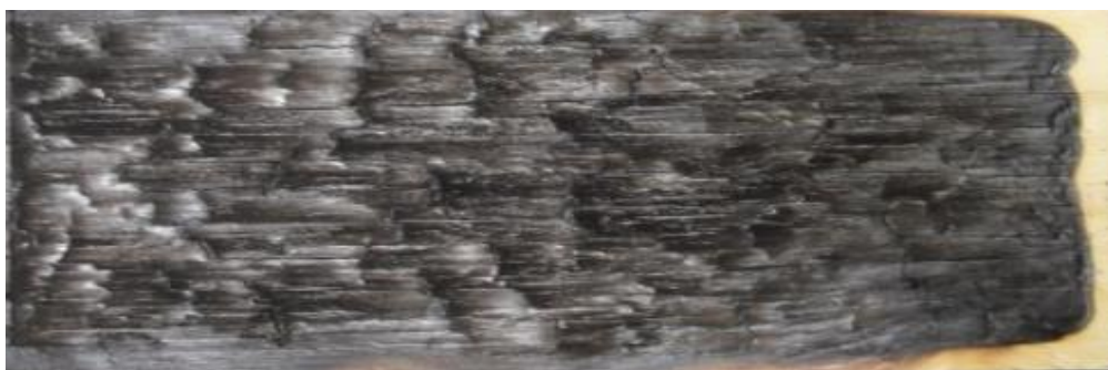
Рис. 3. Элемент деревянной клееной балки типа LVL после огневых испытаний по оценке индекса распространения пламени по ГОСТ 12.1.044-89 (п. 4.19)
