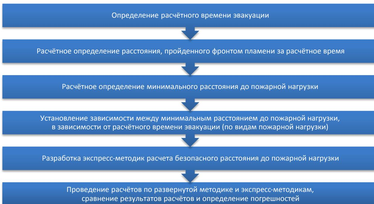
**Рис. 2.1.** Алгоритм редукции методики определения интенсивности теплового излучения пожара с учётом расчётного времени эвакуации людей
