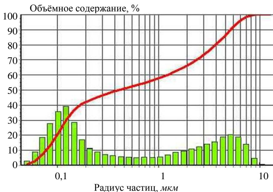
**Рис. 9.** Распределение капель при подаче ТАВ с использованием насадка-распылителя вида "шайба с острой кромкой" при температуре 200 °С
