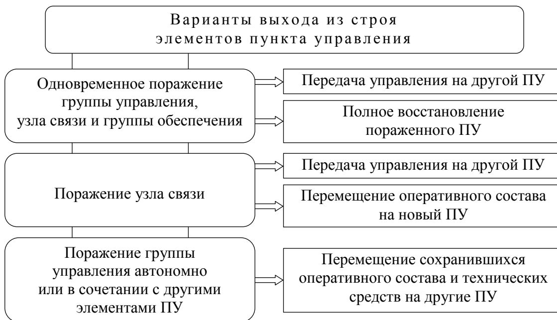
Рис. 1. Варианты выхода из строя элементов пункта управления и способов восстановления нарушенного управления
