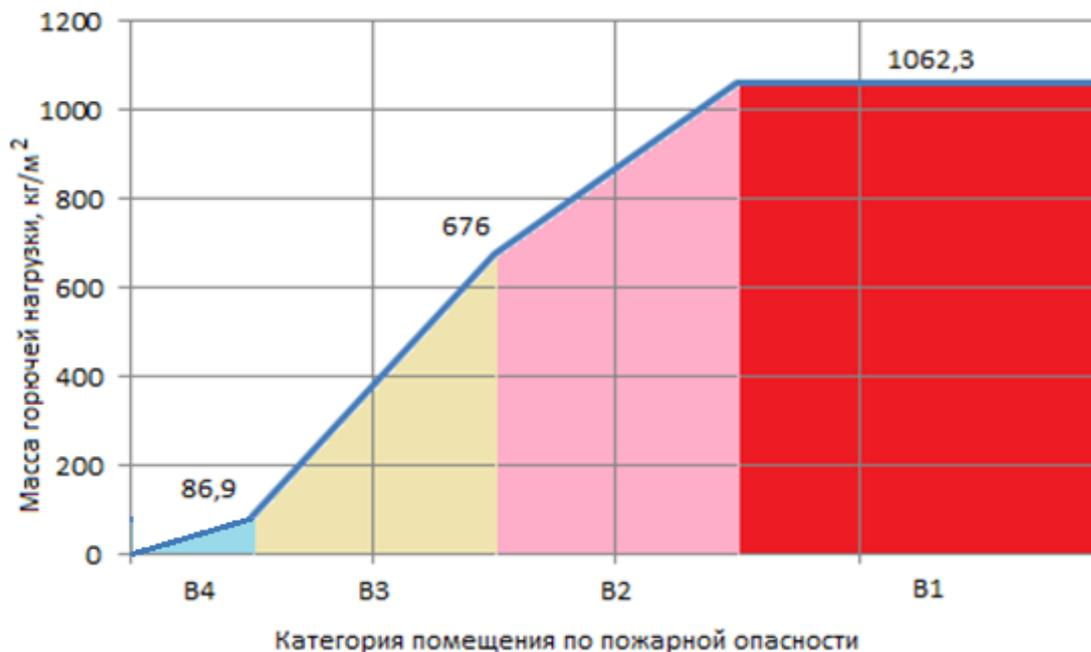
**Рис. 1.** Допустимые массы горючей нагрузки в помещении (кг/м<sup>2</sup>) в зависимости от его категории по пожарной опасности
