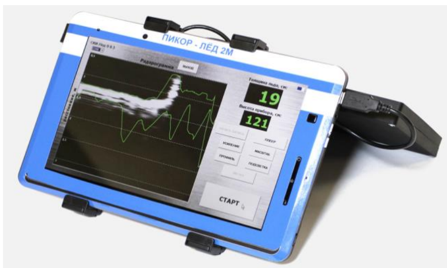
Рис. 1. Многофункциональный портативный радар для измерения толщины льда "Пикор-Лёд"
