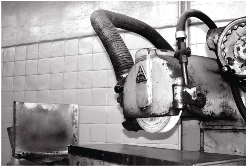
Рис. 1. Станок с экраном, подачей СОЖ и устройством отсоса
