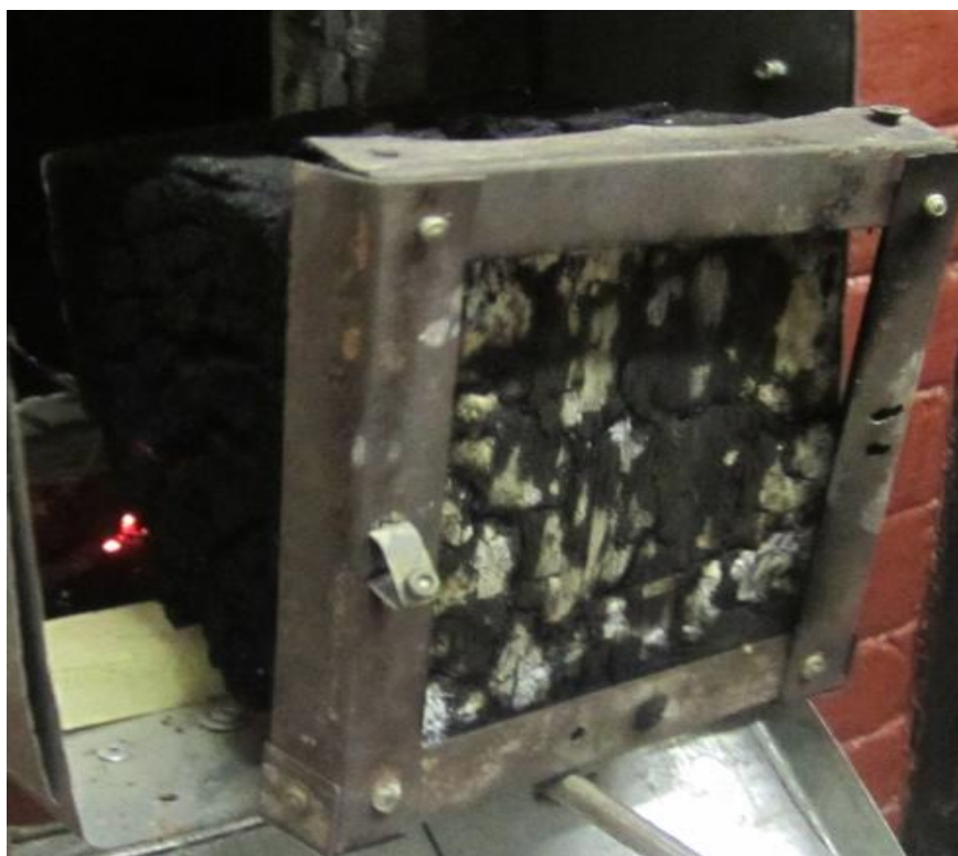
Рис. 3. Характерные термические повреждения материала PENOCOM ® после воздействия стандартного температурного режима пожара
