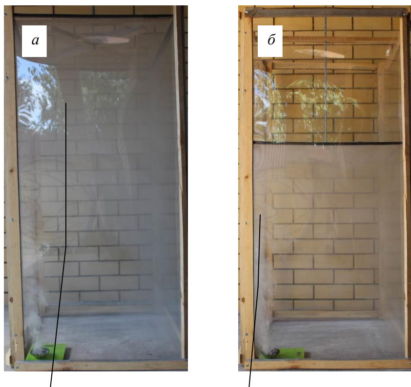
Рис. 4. Характерные фотографии течения внутри экспериментального объёма при расположении горючего материала в углу пола: a - h=1,5 \text{ м} ; b - h=1,0 \text{ м} ; линии – условные границы конвективной колонки
