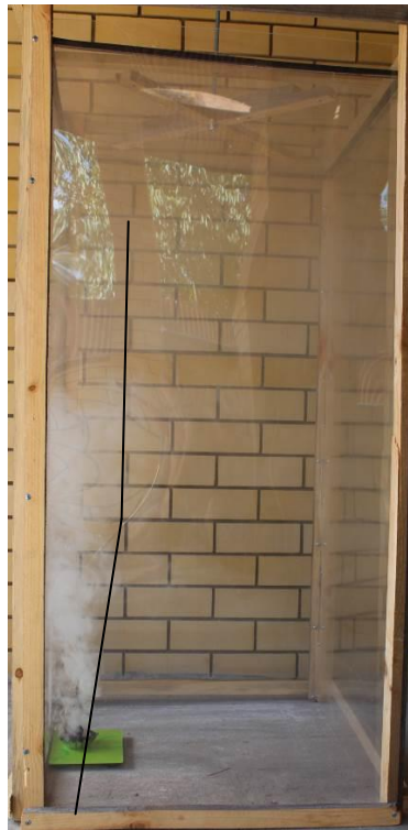
Рис. 5. Характерные фотографии течения внутри экспериментального объёма при расположении горючего материала у стены ( h=1,5 м); линии – условные границы конвективной колонки
