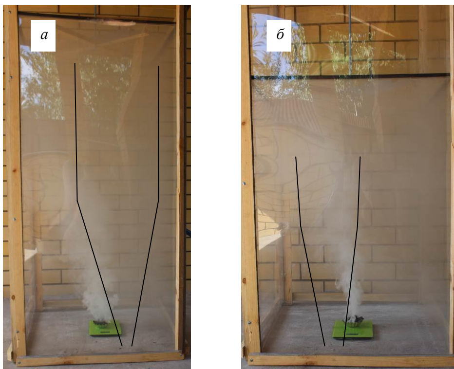
Рис. 3. Характерные фотографии течения внутри экспериментального объёма при расположении горючего материала в центре пола: a - h=1,5 \text{ м} ; b - h=1,0 \text{ м} ; линии – условные границы конвективной колонки
